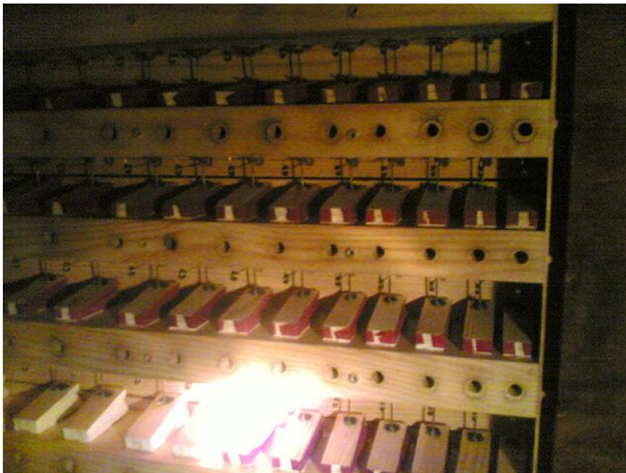
Ikaalisten urkujen III sormion ilmalaatikko avattuna. Suuri osa pikkupalkeista on punaisia, mutta vasemmassa alareunassa näkyy myös valkoista nahkaa.
