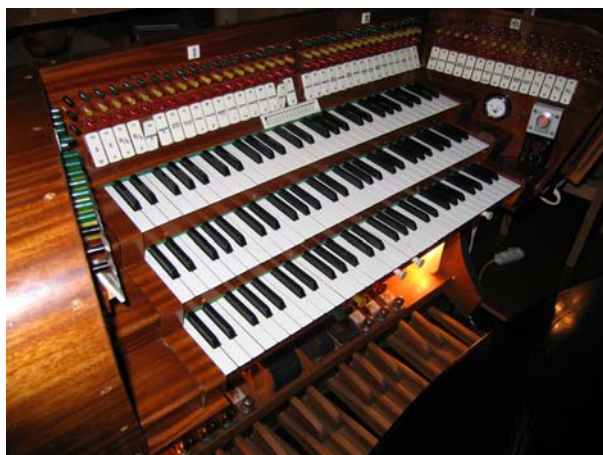
Kuva 2. Ikaalisten urkujen soittopöytä. ”Posket” pöydän sivuilla on pyöristetty erotuksena aiemmin käytössä olleeseen soittopöytämalliin.
