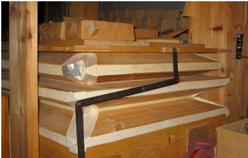
Urkujen osastopalje. Isonpalkeen lisäksi uruissa on 4 osastopaljetta; I sormiolle ja jalkiolle, II sormiolle, III sormiolle ja oma palkeensa Celestalle paisutuskaapin katon päällä.
