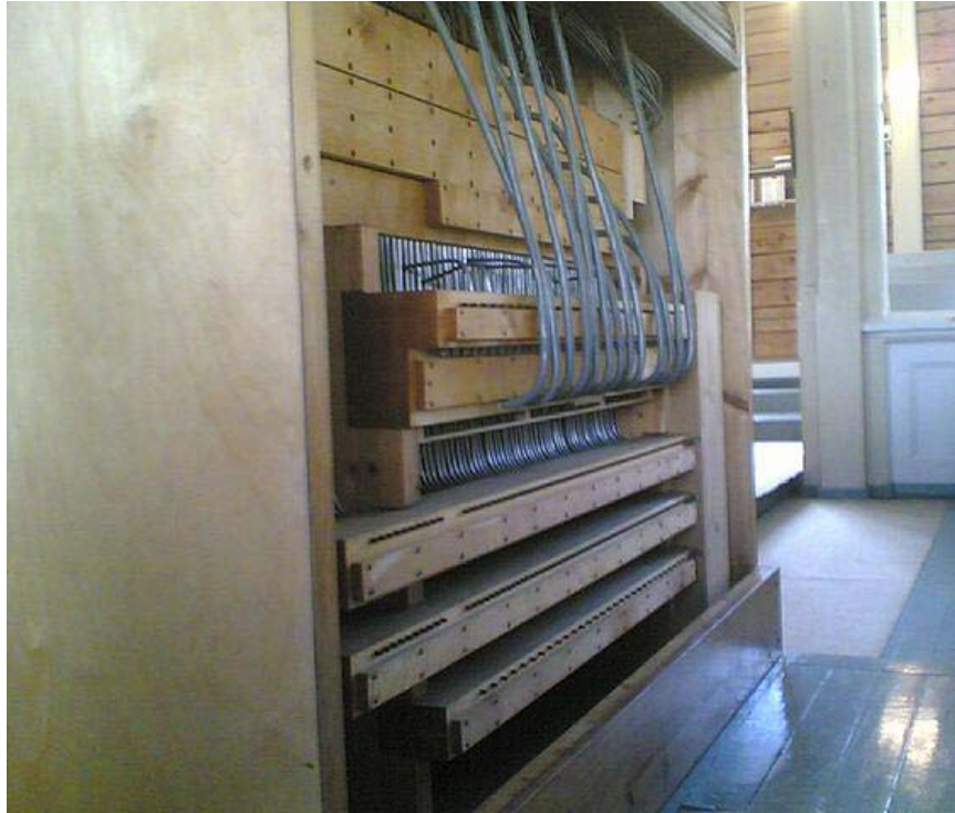
Viekin urkujen pneumaattinen soittopöytä takakansi avattuna. Säätöruuvien rivit ovat näkyvissä.
