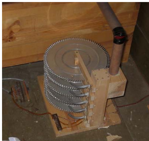
Urkujen osastopalje. Isonpalkeen lisäksi uruissa on 4 osastopaljetta; I sormiolle ja jalkiolle, II sormiolle, III sormiolle ja oma palkeensa Celestalle paisutuskaapin katon päällä.
