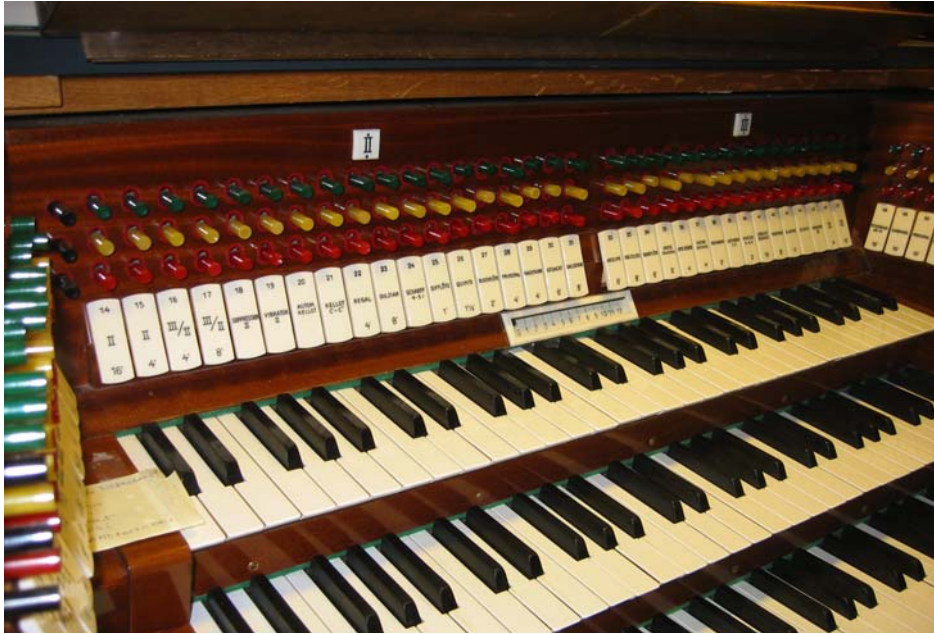
Kangasalan Urkutehtaan uuden mallin mukaiset kombinaationappulat. 1. kombinaatio on vihreä, 2. keltainen ja 3. punainen. Rivien päissä mustat laukaisijanappulat.
