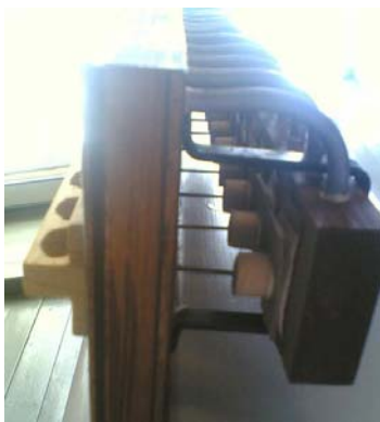
Viekin urkujen vekselipalkeet. Ilmalaatikon kansi irrotettu.
