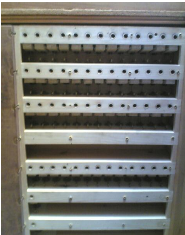
Viekin urkujen II sormion ilmalaatikko avattuna. Pikkupalkeet ovat alkuperäisiä suolinahkapalkeita. Palkeiden nahka on väriltään valkoista ja hyvin ohutta.
