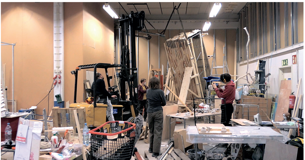
7. Aleksi Martikainen. 2022. Teoksen nostaminen levytiellä oli aikaa vievä operaatio. Työmestari Vesa Rahikainen hitsasi trukkiin jatkopalat nostoa varten, mutta silti nosto piti suorittaa kahdessa vaiheessa. Kuvassa näkyvät puurakenteet estivät teosta kaatumasta noston aikana. Kuva: Tekijä
