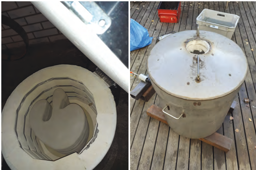
KUVA 14: Suunnittelin veistosten koot niin, että ne mahtui polttamaan Raku-uunissani. KUVA 15: Raku-uuni valmiina polttoihin.
