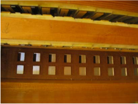
Kuva 12. Non-cassottokielipenkin alla oleva sulkijalista, joka on ylemmässä rivissä hahmottamisen helpottamiseksi puolittain auki ja alemmassa rivissä kiinni.
