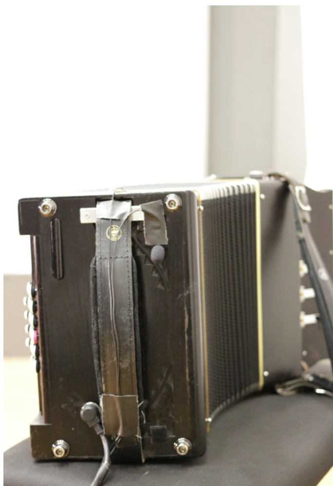
DPA4061 mikrofoni kiinnitettynä bassopuolelle, sijainti ääniaukossa oikealla ylhäällä, joskus myös sijainti alhaalla vasemmalla, valokuva Matti Strahlendorff.
