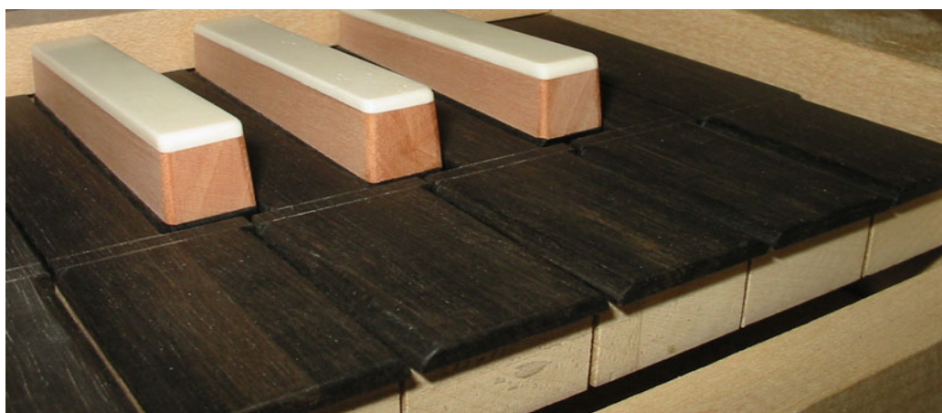
Kuva 4.1 Kuva koskettimien pyöristyksistä ja koristeviilauksista.
