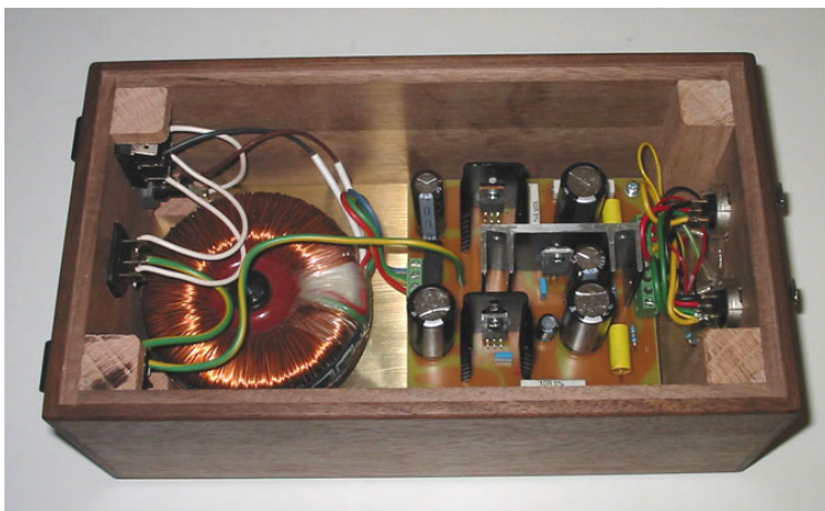
Kuva 4.8 Ulkoinen virtalähde ilman kansilevyä.
