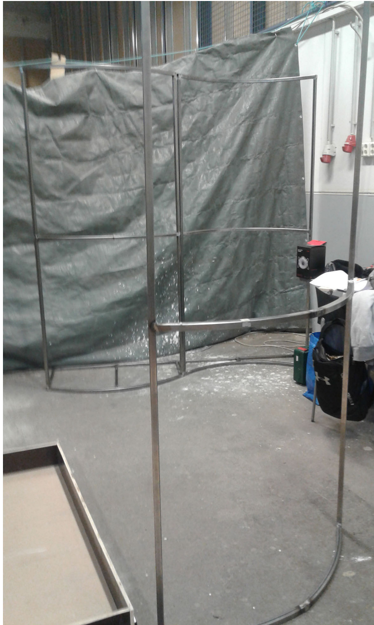
Teräsputkesta tehtyjen kehikkojen työstöä. Kuva : Jaakko Lahti
