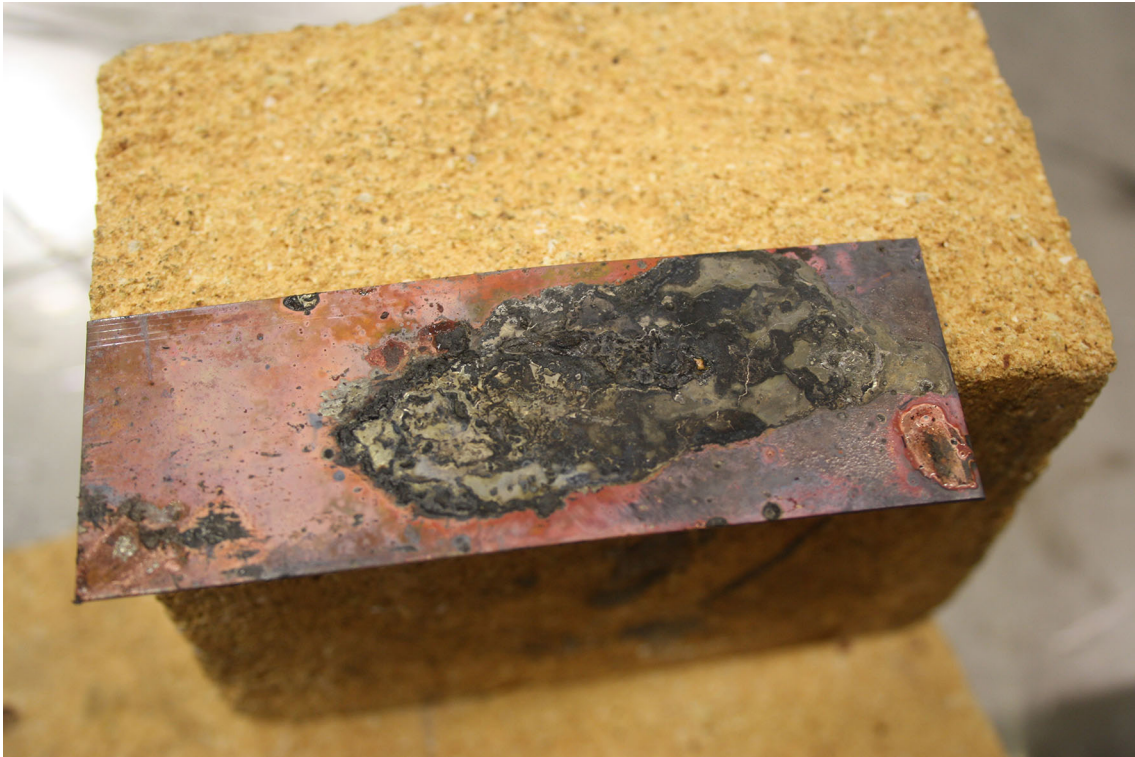
Polttimella kuumennettu kuparilevyn pala. Kuparilevyn päälle sulanutta tinaa. Kuva : Jaakko Lahti
