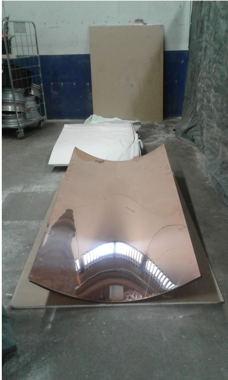
Kuparilevyn mallausta teräsputkikehikkoon. Kuva : Jaakko Lahti
