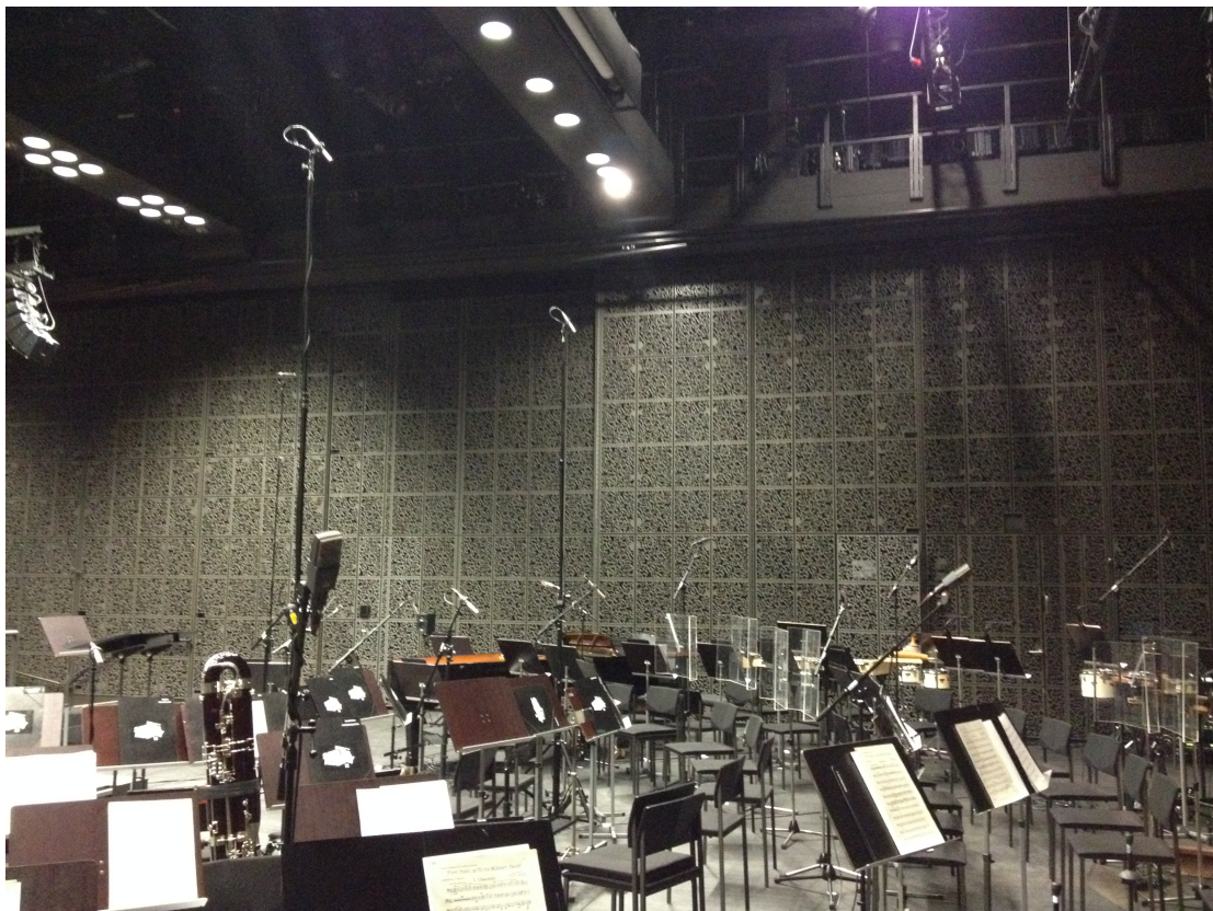
Kuva 8. Baritonitorvien istumapaikoilta otettu kuva, jossa näkyy baritonisektion AKG C414B-XLS:llä tehty lähimikitys. Oikealla kuvassa on erotettavissa esimerkiksi pasuunasektion 414-mikrofoni ja vasemmalla kuvan ylälaidassa overhead-mikrofonit (Schoeps CMC6 & MK5).
