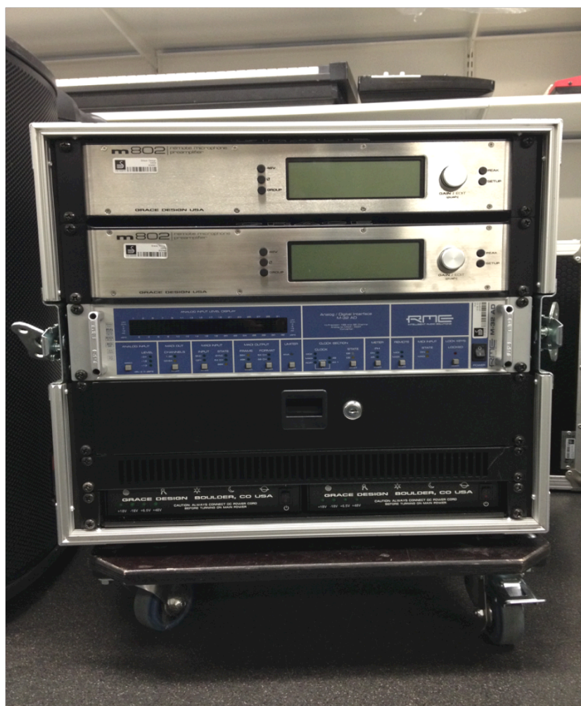
Kuva 3. Grace-räkki musiikkiteknologian varastossa. Räkissä kaksi 8-kanavaista Grace Designin m802 -esivahvistinta ja RME M-32 AD-muunnin.
