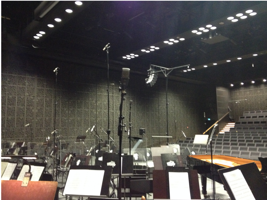
Kuva 11. Käyrätorvistien istumapaikkojen takaa otettu kuva. Etualla näkyy käyrätorvien lähimikrofoni AKG C414B-XLS. Kauempana kuvassa näkyvät flyygelin lähimikrofoni, Decca Tree, overheadit ja puhaltajien lähimikityksiä.
