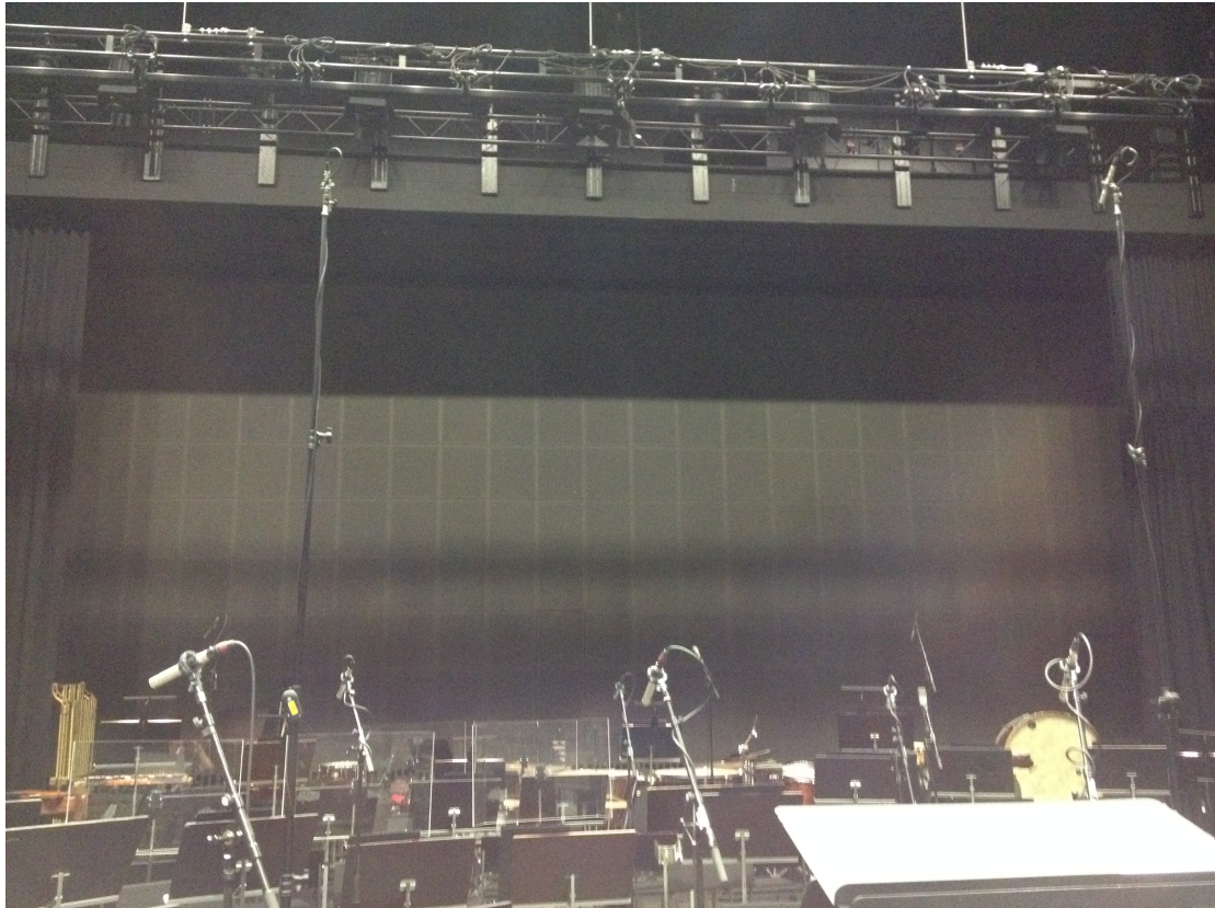
Kuva 10. Overhead-mikrofonit ja puupuhaltimien lähimikityksiä (Schoeps CMC6 & MK5) kapellimestarin paikalta katsottuna.
