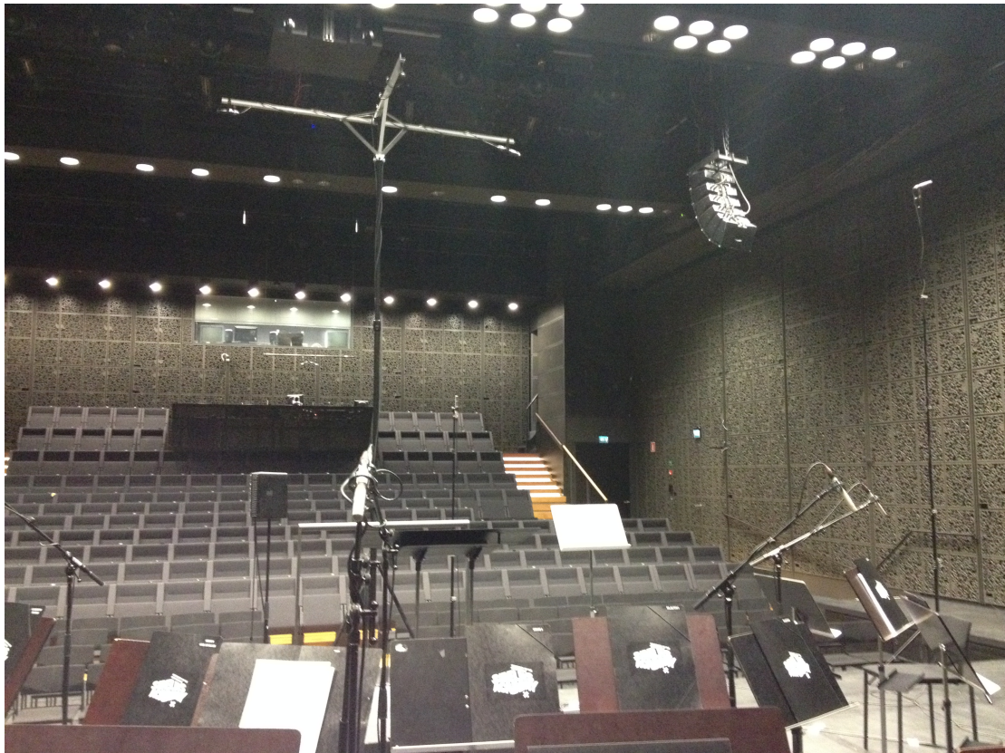
Kuva 7. Mikityksiä Sonoressa. Etualalla puupuhaltimien lähimikrofoneja ja kuvan ylälaidassa Decca Tree -päämikrofonit ja vasemman laidan tukimikrofoni. Kauempana kuvassa näkyvät myös trumpettisolistin AT4081 ja tarkkaamon edessä kattorakenteista roikkuvat tilamikrofonit. Kuvassa näkyy myös talkbackia varten kapellimestarin korokkeen viereen sijoitettu Genelec-kaiutin.
