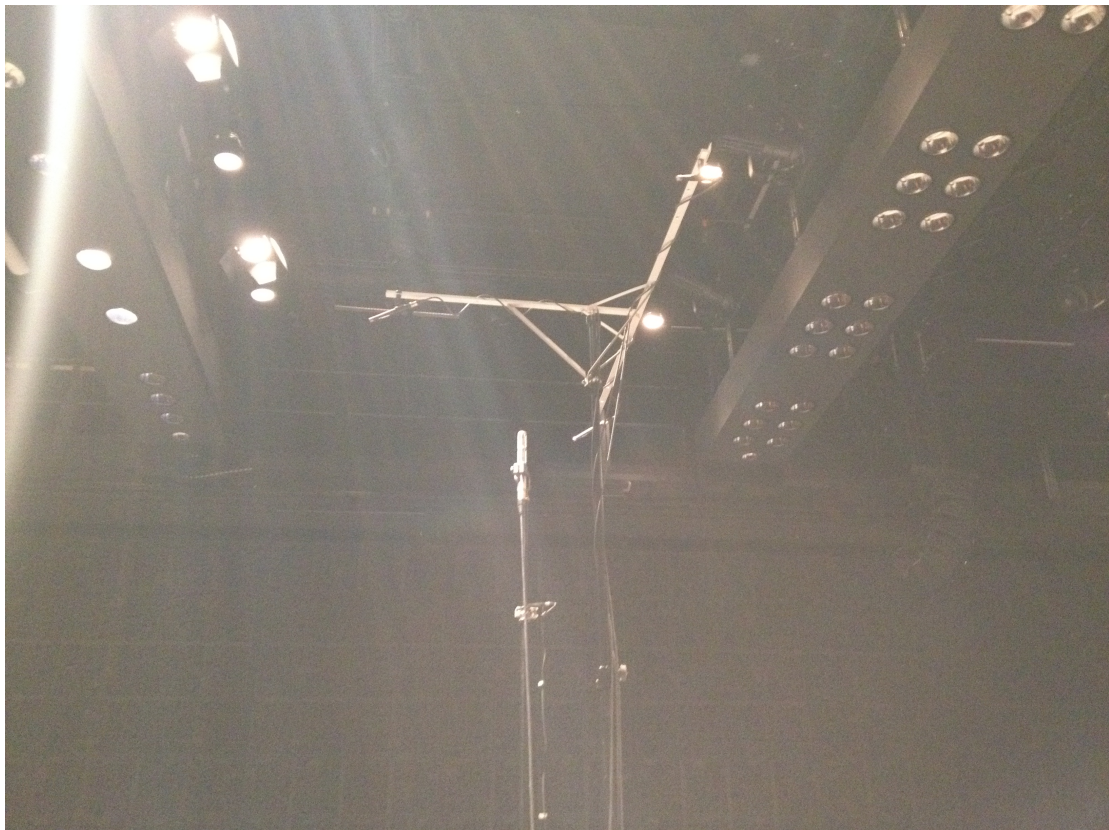
Kuva 4. Academy Winds -äänityksissä käytetty Decca Tree -mikitys ja trumpettisolistin AT4081 ribbon-mikrofoni.
