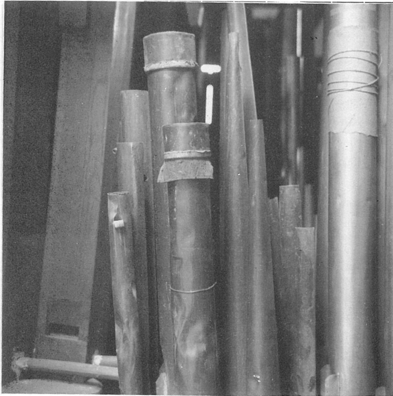
Bild 40. Detalj av det inre pipverket. Från vänster: en trägedakt, kvintpipor, metallgedakter, spetsflöjter, oktavapipor och längst till höger en senare tids pipa på trumpetens plats. Foto J. Martikainen.
