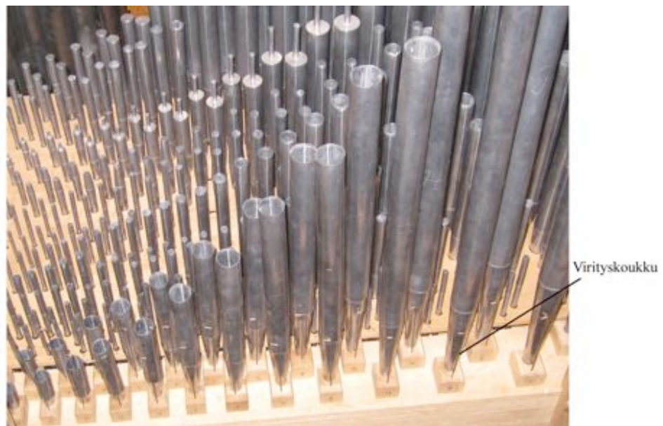
KUVA 4. Kielipillejä. Kaksi ensimmäistä riviä edessä ovat kielipillejä, takana olevat pillit ovat huulipillejä.
