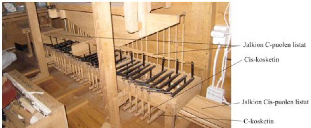
KUVA 12. Jalkion soittokoneisto soittopöydän takana.
