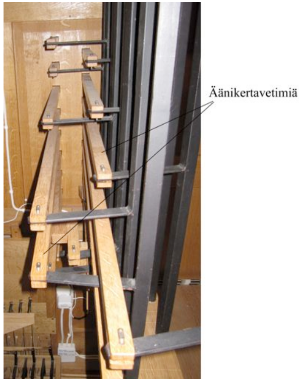
KUVA 16. Äänikertojen mekaaninen hallintalaitteisto (osa) urkujen sisällä.
