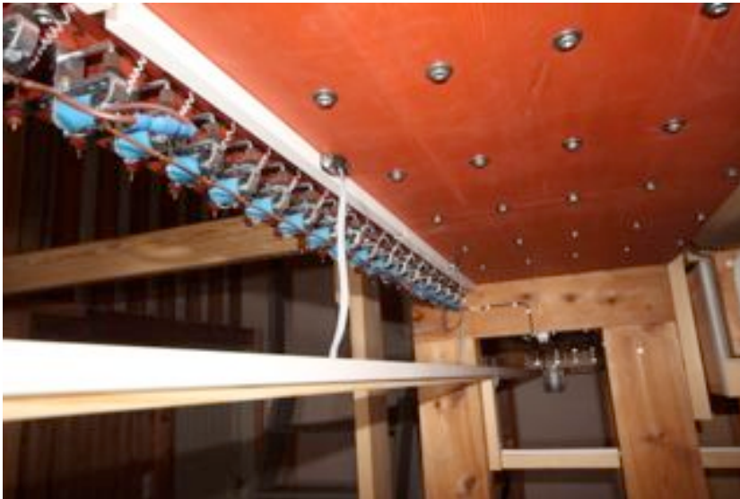
KUVA 15. Helsingin Paavalinkirkon lehteriurkujen 61 sähköpneumaattisen soittokoneiston releet rivissä vasemmalla. (Kuva: Pekka Suikkanen)
