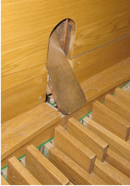
KUVA 24. Helsingin Musiikkitalon Organo-salin Forster & Andrews -urkujen pausutuskaapin vaakapoljin (kiinni).
