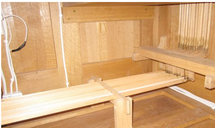
KUVA 13. Jalkion soittokoneisto (osa); Cis-puolen listojen suunnanvaihto.
