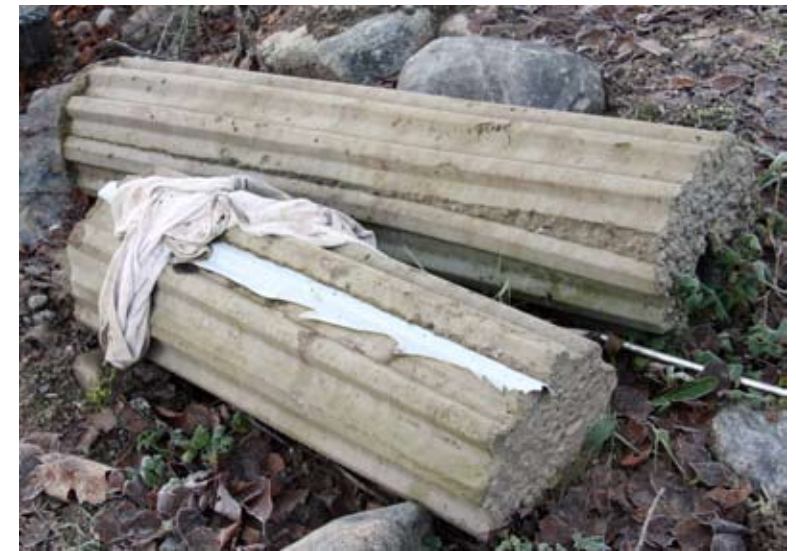
Provgjutning av de grekiska pelarna av betong.
