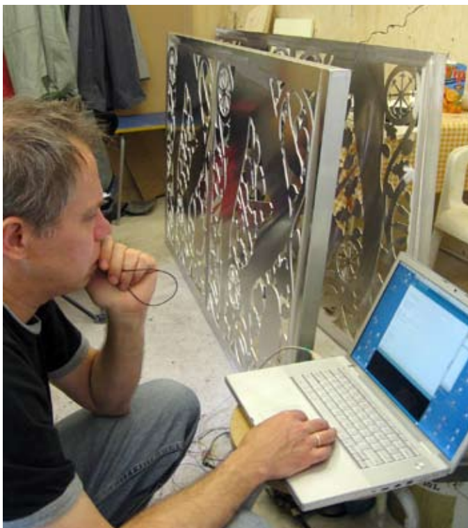
Ljudkonstnär Shawn Decker testar tekniken med att inkorporera små högtalare, med egna ljud genererade med datorprogram, i broräcksornamentiken. Sensorer, som mäter förändringar i ljus och temperatur utanför huset, förändrar ljuden. 2007.
