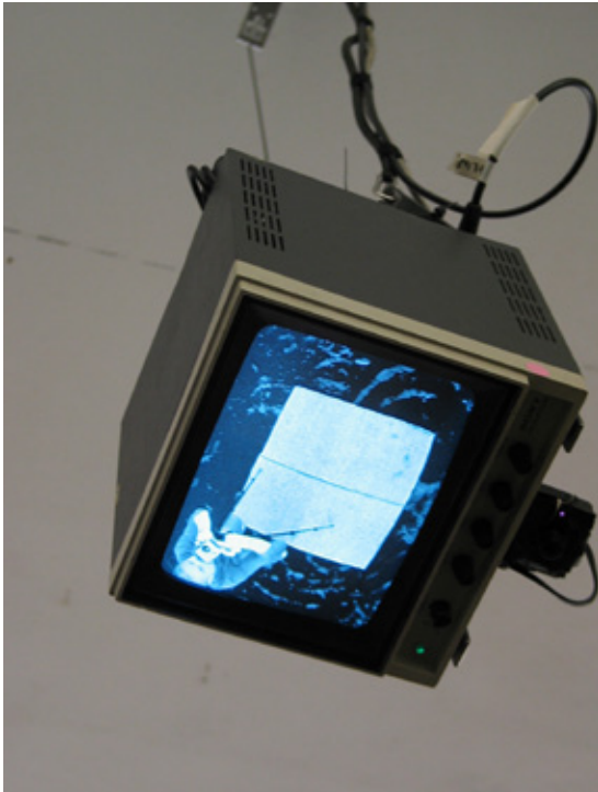
Kuva 36: Monitoriin kiinnitetty pieni videokamera kuvasi sen alapuolelle asettunutta henkilöä infrapunaLED:nsä avustamana, jolloin reaaliaikainen monitorikuva samalla valaisi henkilön. Mitä lähempänä kameraa henkilö oli, sen kirkkaammin kuvaputki valaisi.
