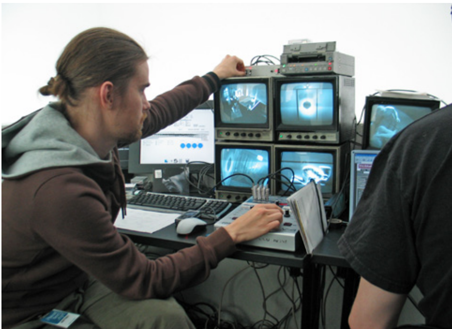
Kuva 35: Teemu Määttänen ja Juha Storm työskentelivät esitystilan ”eteiseen” rakennetussa video- ja äänitarkkaamossa. Monitoreihin välittyi infrapunavalaistuksen avulla selkeää kuvaa esitystilasta riippumatta sen valaistuksesta.
